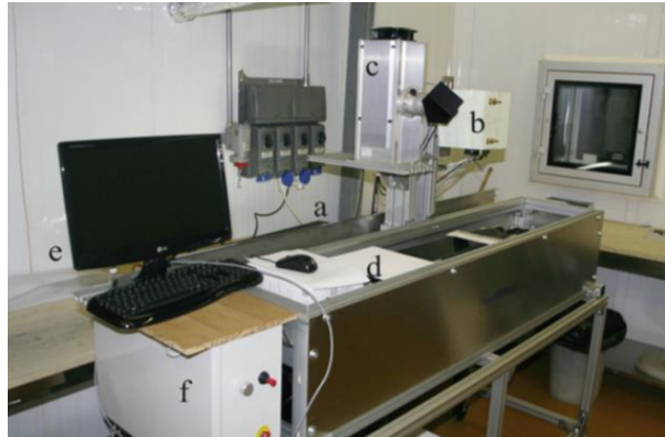
Fig. 1: Sistema iperspettrale formato da: a) sistema ad alta precisione con porta campioni e driver motore; b) Telecamera HeadWall; c) lampada alogena; d) pannello Lambertian Spectralon®; e) PC collegato allo spettrometro; f) Single-Board RIO – Credit: Garzonio et al.
